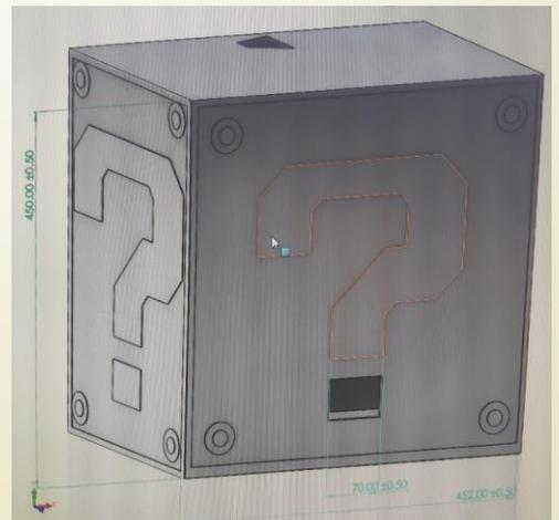
確定所以尺寸沒有錯誤的時候，就可以使用亞克力膠的材料來製作實體模型了，而考慮到人手切割的方法會以一定的誤差，所以我這次使用的是鐳射切割，將我畫好的各個平面圖切割出來。最後將他們粘好拼好，就成為左邊那幅圖的樣子。
